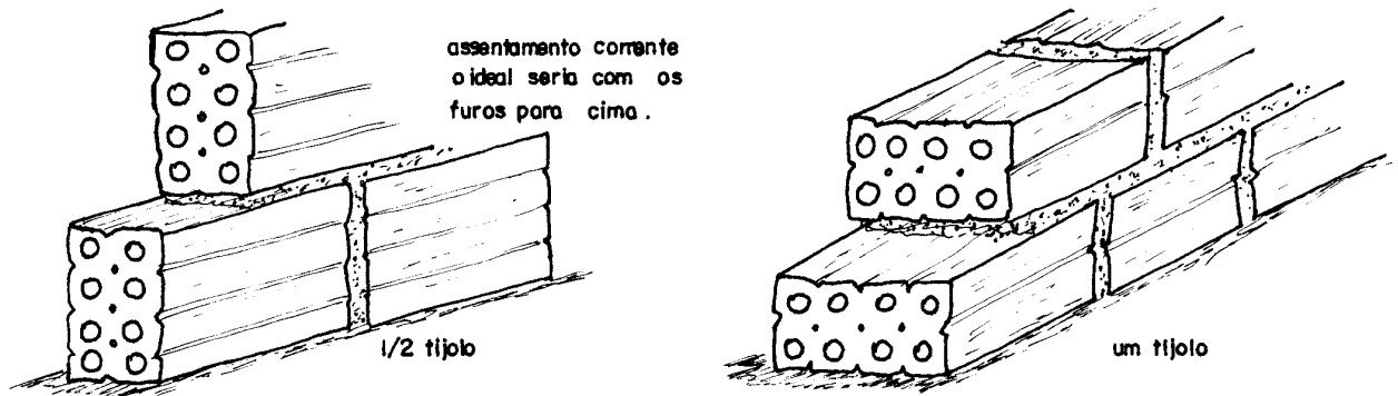
Figura 1 - Execução de alvenaria utilizando tijolos furados.
